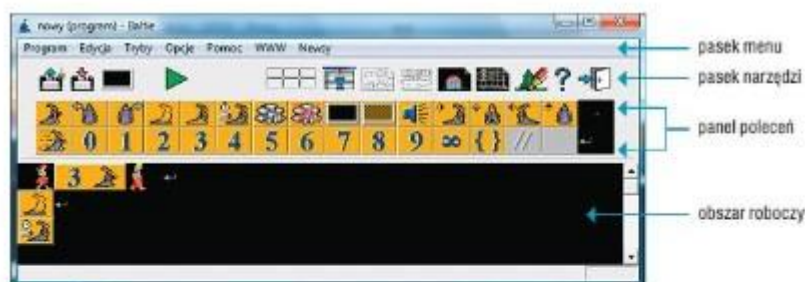
Rys. 1. Okno programu Baltie otwarte w trybie Programowanie/Nowicjusz. Na scenie jest widoczny krótki kod programu
